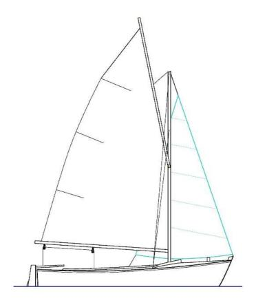
Construction: sandwich polyester nid d'abeille stratifié avec réserves d'air Plancher: 5.50 mètres Longueur hors tout: Largeur au maître bau : 2.06 mètres Tirant d'eau: 0,20/1,10 mètres Surface de voilure : 16 m<sup>2</sup> Grand-voile: 11 m<sup>2</sup> Génois:  $5 \, m^2$ 420 kg Poids complet: Cockpit: auto videur
